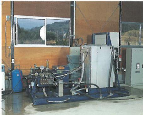
コンパクトなプランジャーポンプから1,500kg/cm<sup>2</sup>の超高压水を発生させます。
