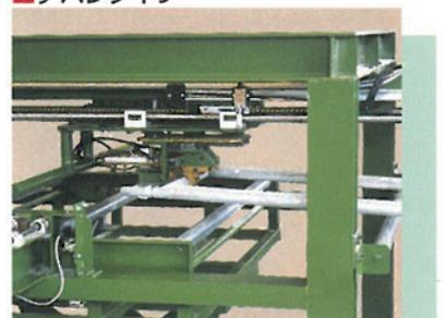
建築現場より返却された建枠を検収の上、要ケレン建枠を積み上げておくと、自動的にケレン機へ投入します。
