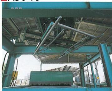
筋カ止めピンをハンドリングする際に、建枠の歪みや寸法くずれ等の異常も検出することができます。
