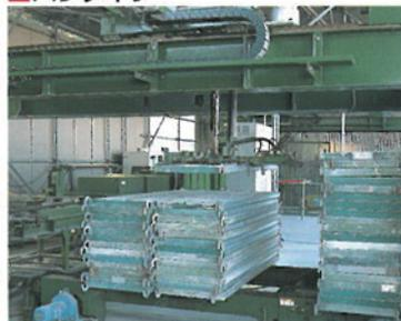
ケレン作業後の足場板を荷くずれのないように正確に積み上げます。
