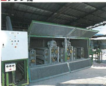
シンプルな機構と長耐久力のフローリングケレン機で付着コンクリート等を除去します。
