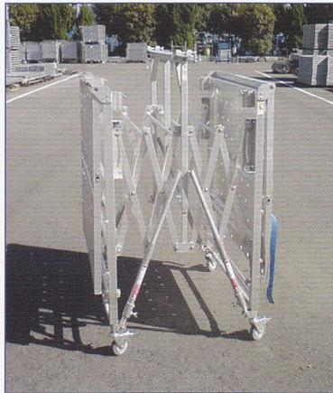
車輪のロックを解除し、蛇腹構造により左右に開く。
