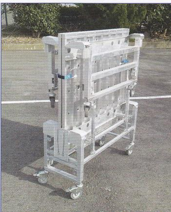
車輪をロックし収納バンド、脚ロック金具を解除する。
