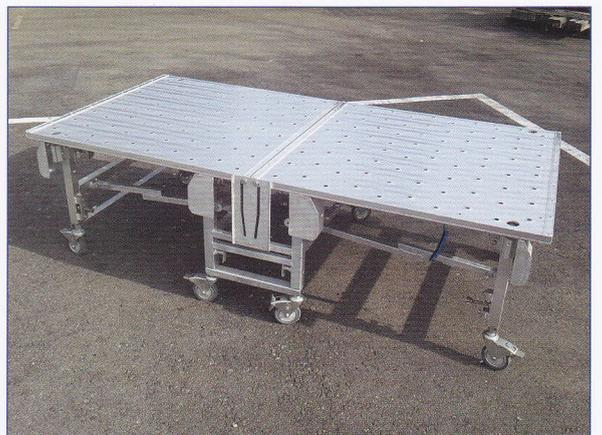
上昇作業は中央部分より行い、使用高さに設定後、外側の両脚部を設定高さへと調整する。
