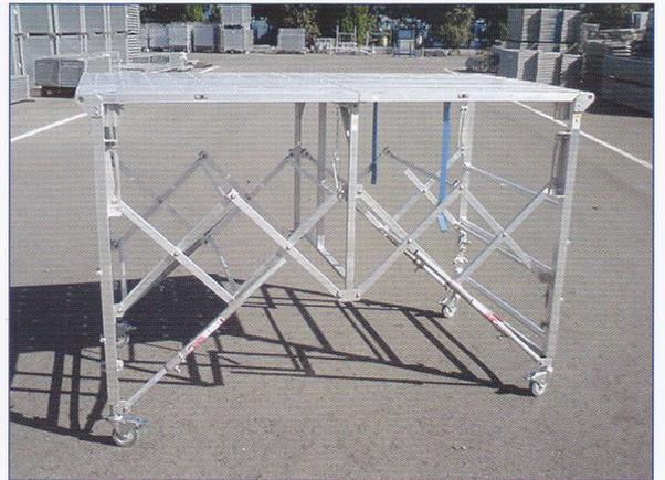
蛇腹部をしっかりと開き、床板を回転させ上部へとセットし各部をロックさせてください。
