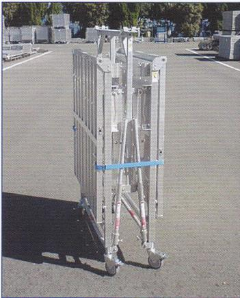
収納バンドを外し、振れ止め材のボルトを緩める。
